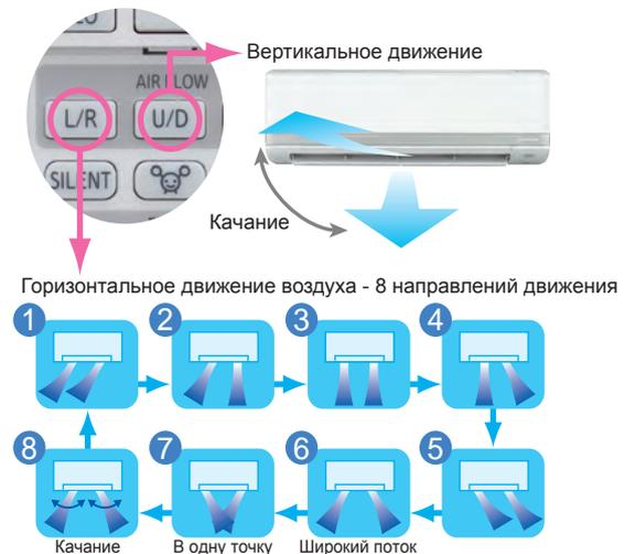
С помощью управления правой и левой частью заслонок можно отдельно регулировать направление воздушных потоков от правой и левой частей кондиционера. Возможна настройка предпочтительного направления воздушного потока, а также определение, требуется или нет прямой воздушный поток, с минимизацией потерь энергии и повышением эффективности.
